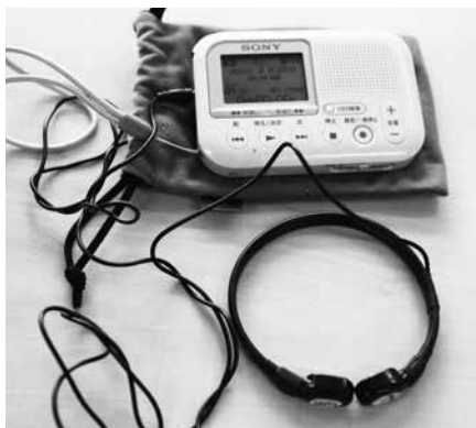
ミールラウンド時に活用している「咽喉マイク」。食事中、利用者の喉元に装着することで、視覚的に分かりづらい嚥下音を確認することができる。誤嚥防止にも有用だ。
